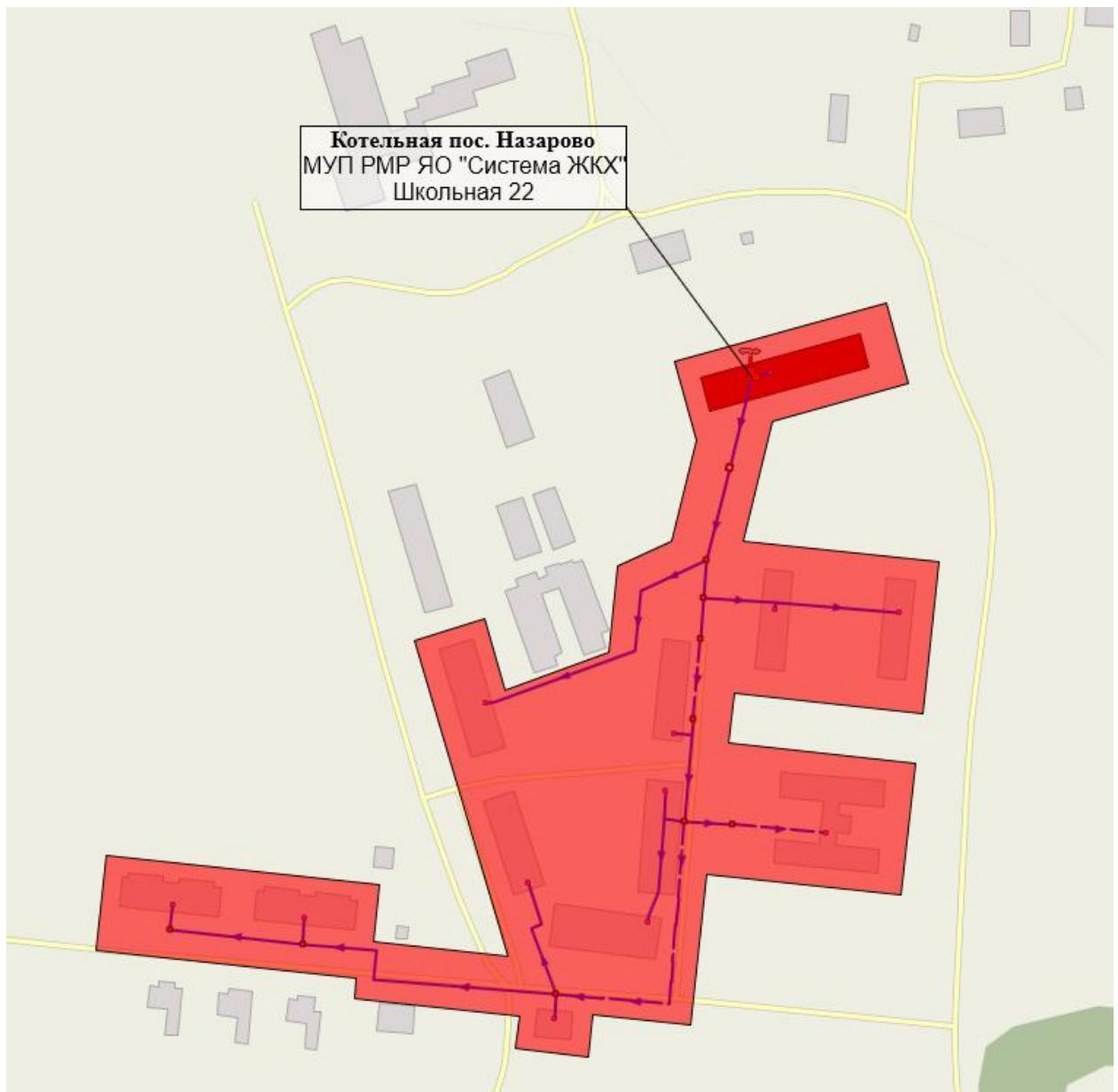
Рисунок 9 – Зоны действия котельных (часть 1)
