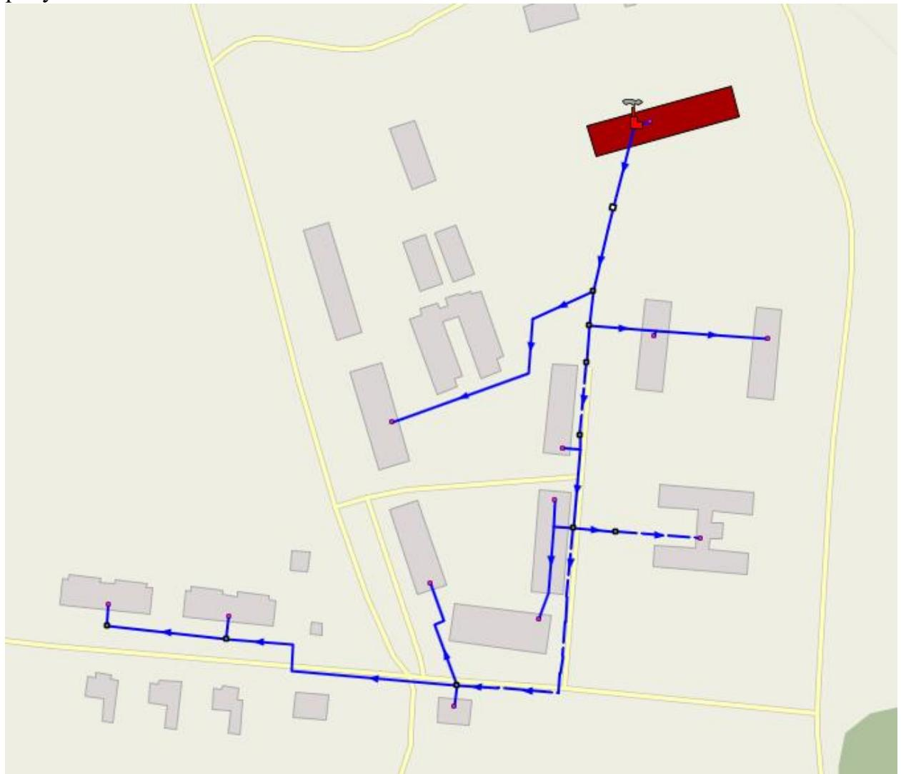
Рисунок 5 – Схема тепловой сети от котельной д. Назарово
