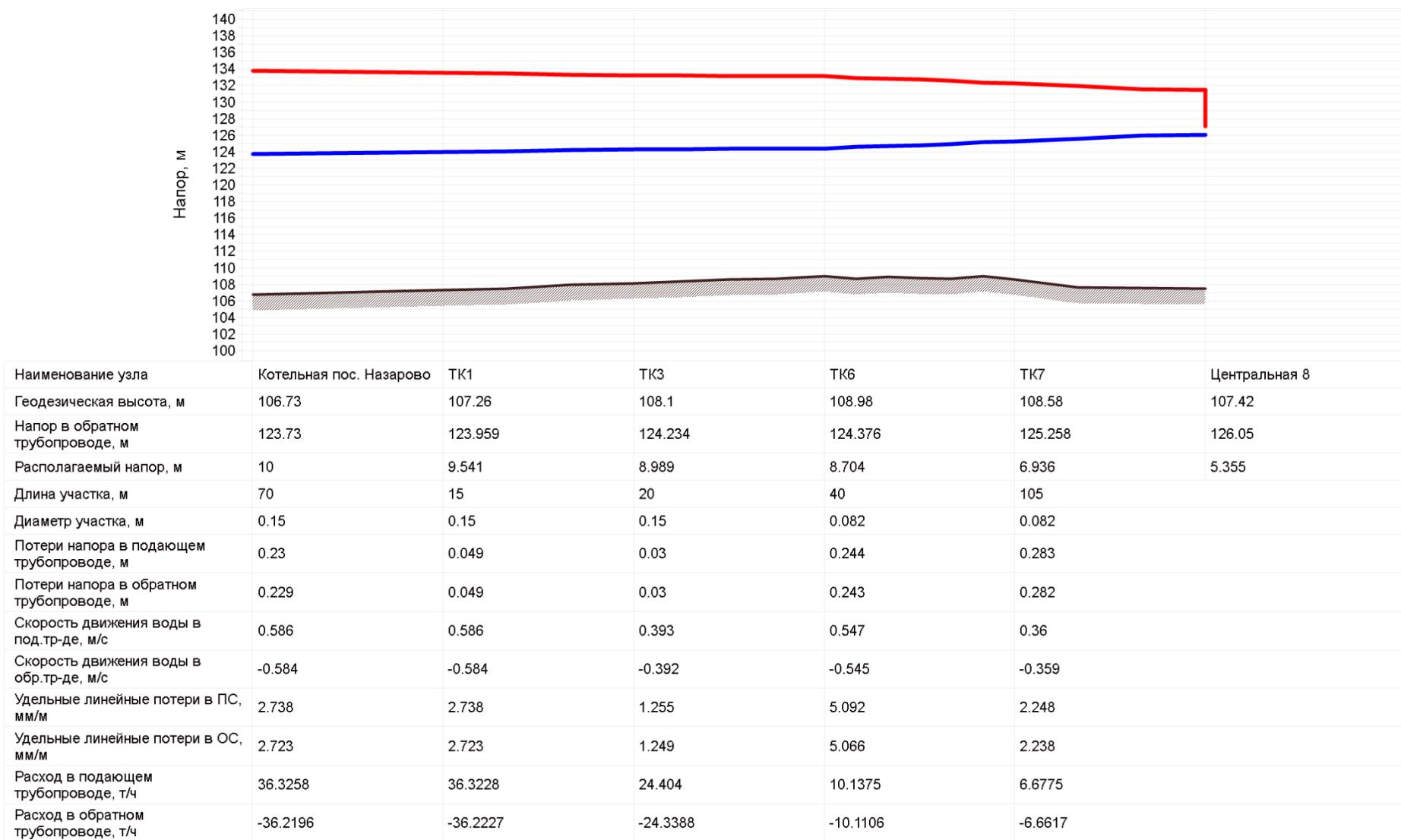
Рисунок 12 – Пьезометрический график от котельной д. Назарово
