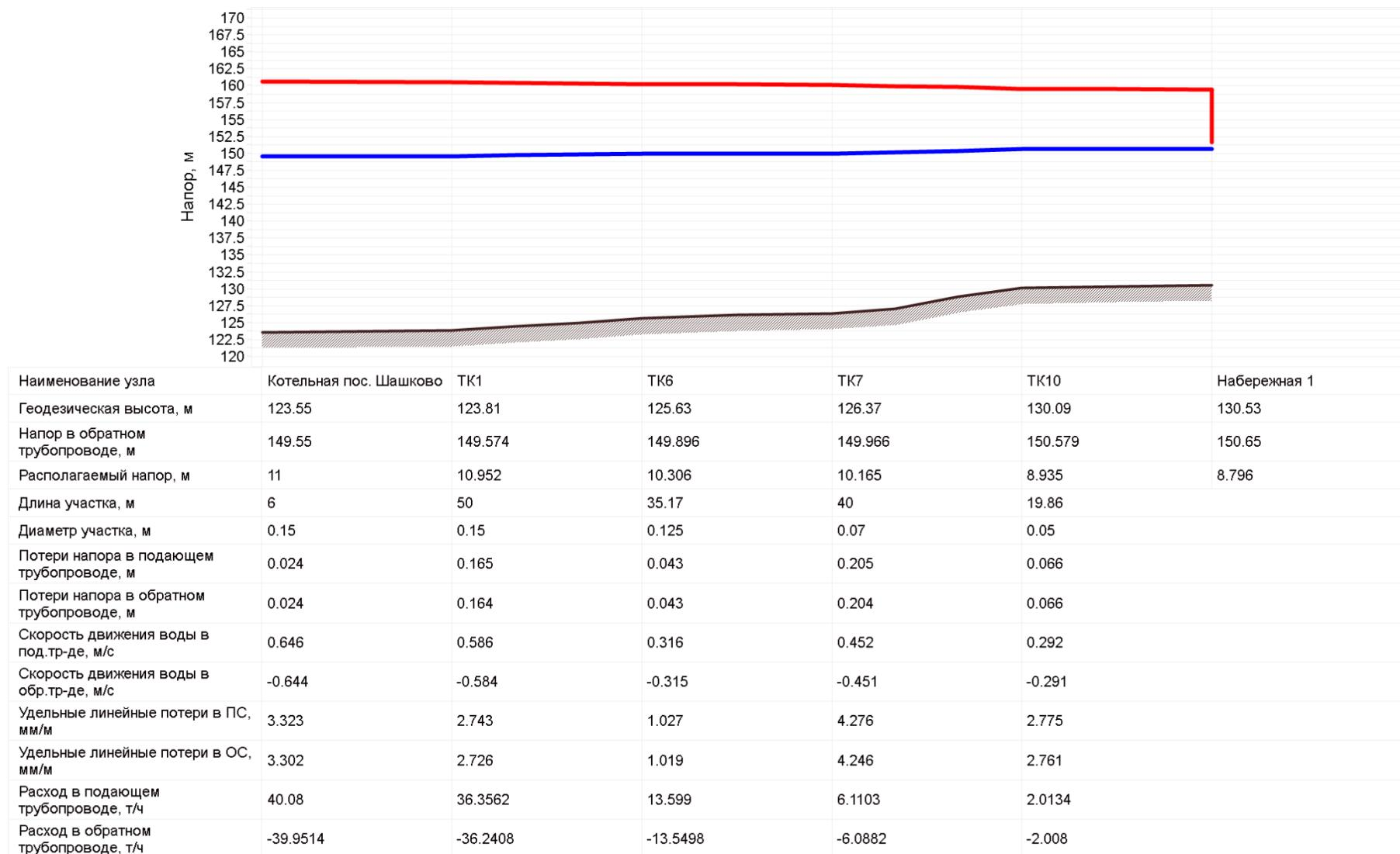
Рисунок 13 – Пьезометрический график от котельной пос. Шашково
