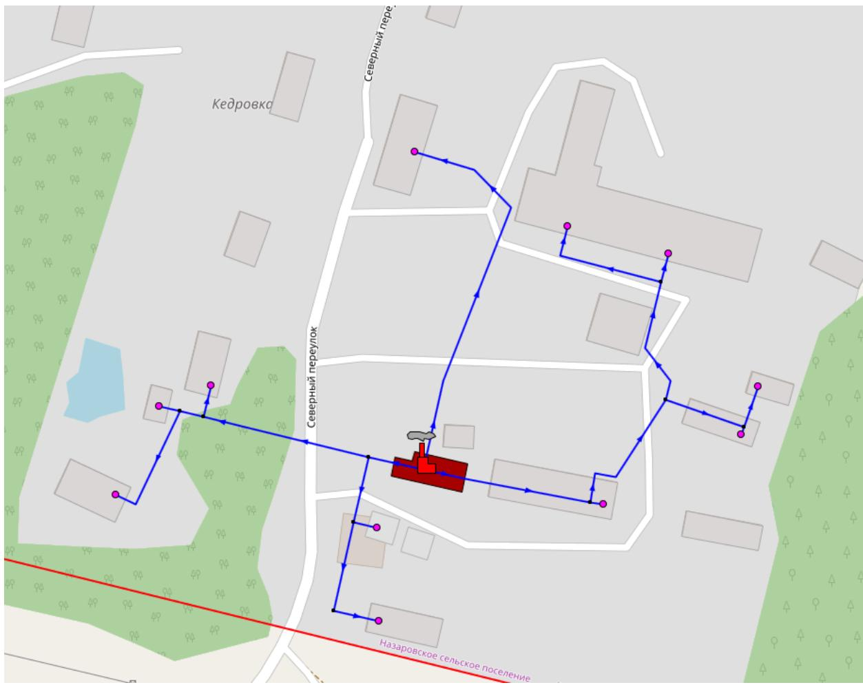
**Рисунок 7 – Схема тепловой сети от котельной пос. Кедровка**
